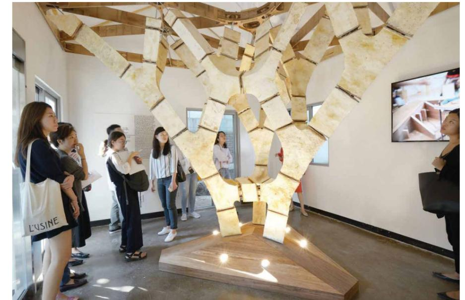
Der MycoTree ist eine Struktur aus Pilzmyzel und Bambus. Seoul Biennale of Architecture and Urbanism 2017. The MycoTree is a structure made of fungus mycelium and bamboo. Seoul Biennale of Architecture and Urbanism 2017.
