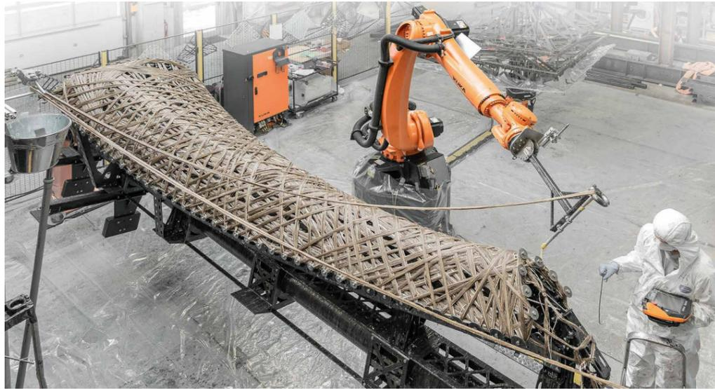
Roboterassistierte Fertigung eines Flachsfaser-Bauelements. The robot-assisted production of a flax fibre component.
